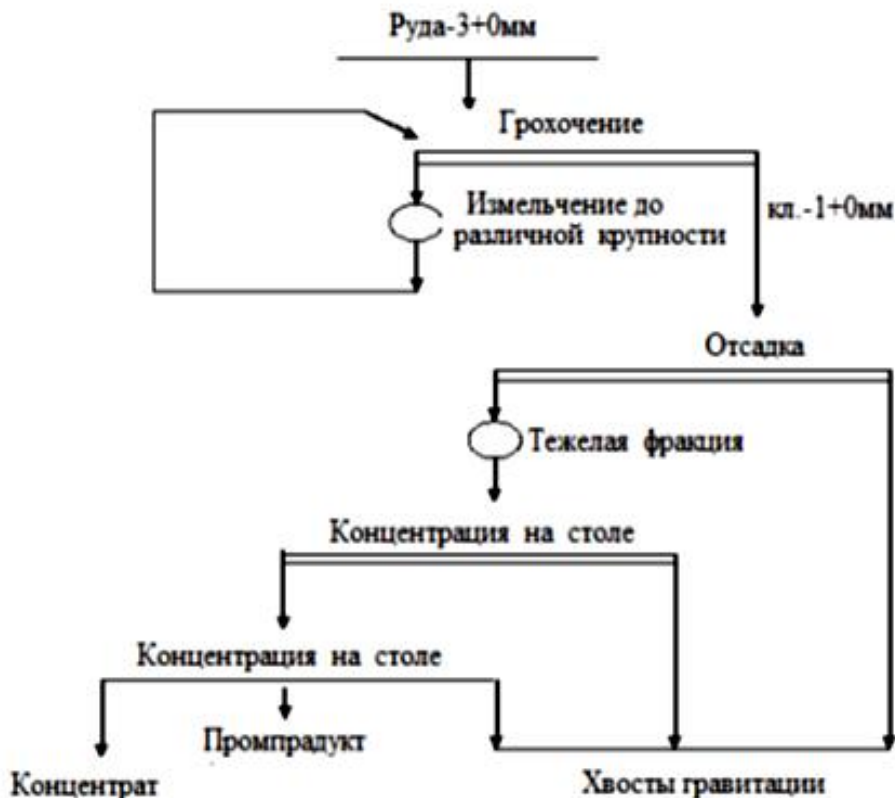
Рис. 1. Технологическая схема гравитационного обогащения руд
