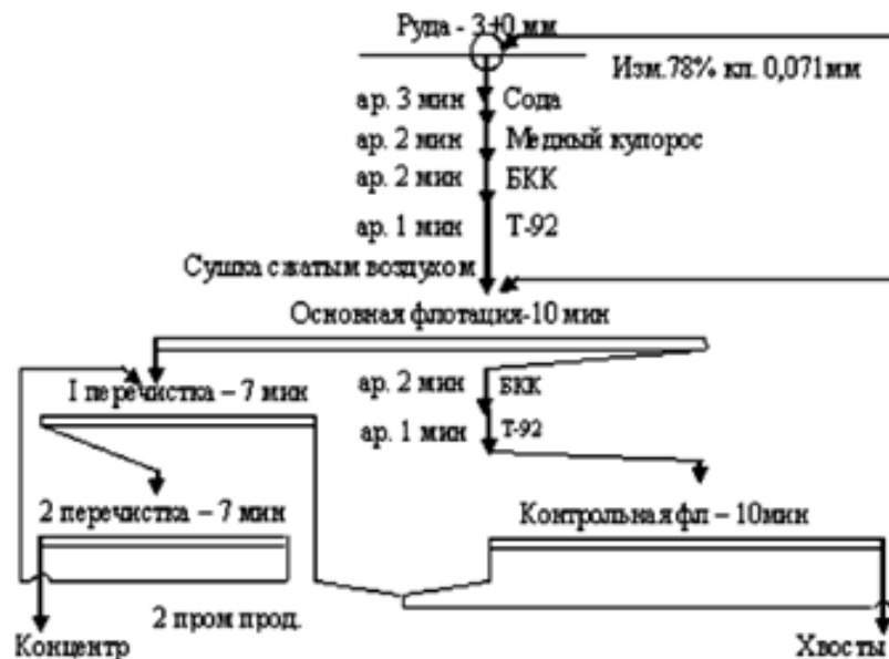
Рис 2. Схема флотационного обогащения руды
