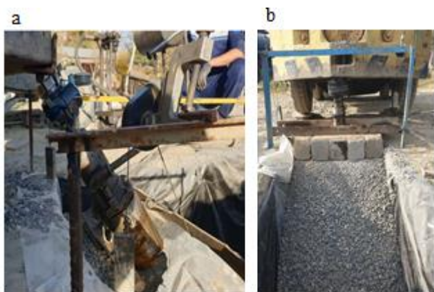
2-расм. Шағал қияликларини синовдан ўтказиш жараёни. а- α бурчак бўйича, б- вертикал ўқ бўйича
