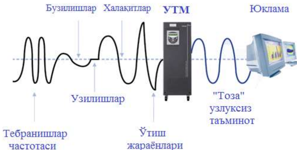
Rasm 1.1. Tarmoqdagi nosozliklardan UTMni himoyalash sxemasini
